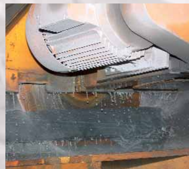
Glück auf! Gut gelaunt geht's unter die Erde: Michael Mudra (l.), Thomas Fischer (r.). Der Schieferabbau mit Diamantsägen (o.r.) ist ein staubiges und lautes Geschäft; die tischgroßen Gesteinsplatten werden mit imposanten Trennscheiben geteilt
